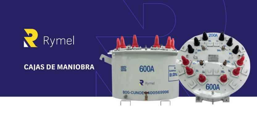
La línea de cajas de maniobra marca Rymel, ofrece equipos altamente seguros, aisladas y refrigeradas en aceite, con capacidad para realizar operaciones de seccionamiento bajo carga en líneas de media tensión de sistemas subterráneos. Se utilizan para transferir cargas de un circuito principal a otros circuitos secundarios. Pueden ser del tipo Pedestal o del tipo sumergible, para circuitos monofásicos o trifásicos.
